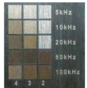
» Slika 6: Krmiljenje količine oksidov na površini kovine omogoča izdelavo različno obarvanih površin.
