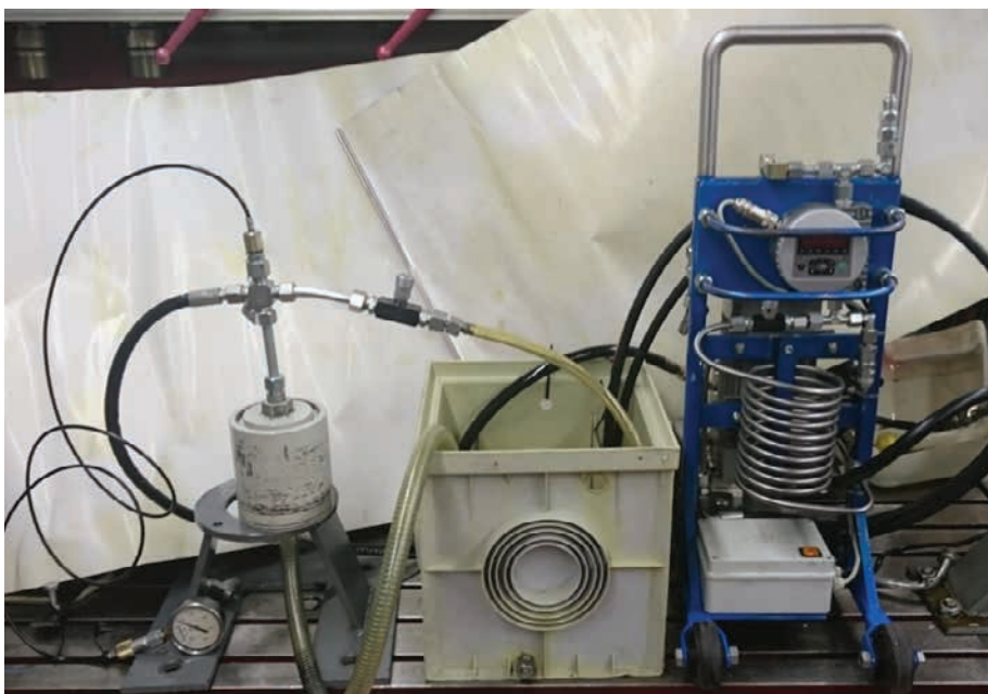
» Slika 6: Ispitna stanica filtarskih materijala.
