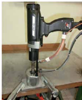
» Slika 7: Oprema za a) kondenzatorsko zavarivanje čepova [3] i b) za SRM zavarivanje čepova [2]
