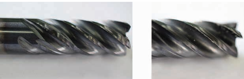
» Primerjava obrabe rezila orodja, obdelave, materiala – levo s sistemom powRgrip, desno brez sistema powRgrip
