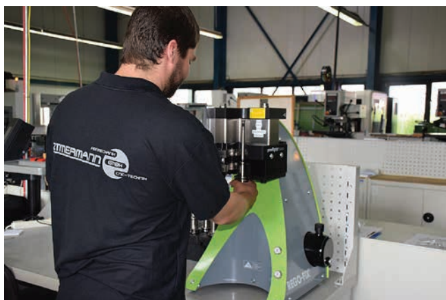
» Sistem powRgrip – edinstveni sistem za vpenjanje orodja, ki s pritiskom na gumb v nekaj sekundah vpne orodje brez segrevanja in nepretrgoma deluje z natančnim krožnim tekom tudi pri najmanjših premerih orodja
