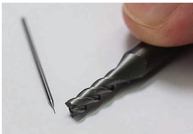
» Aluminij z majhno napetostjo (posnetek od blizu z mikroorodjem) – orodje za rezkanje s premerom 0,15 mm
