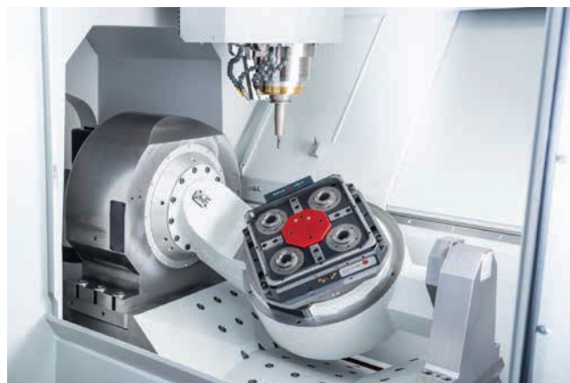
» Slika 3: Stroji Röders omogočajo obdelavo v območju natančnosti mikronov.
