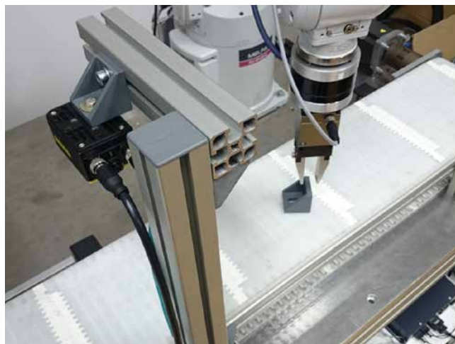
» Slika 8: Položaj robotske ruke trenutak pred podizanjem komada
