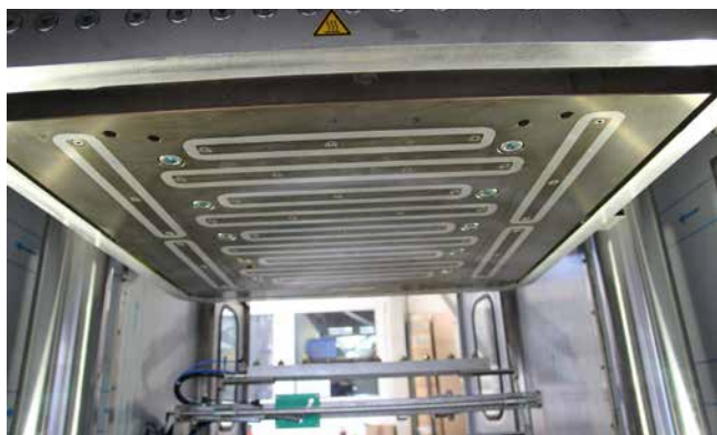
» Gornja magnetska stezna ploča za drugu polovicu alata
