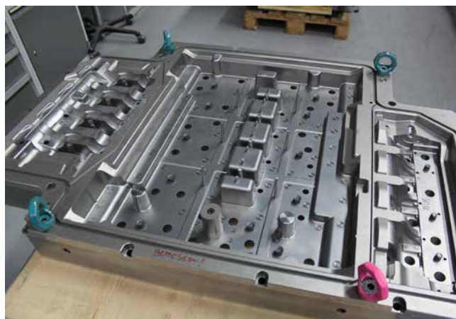
» Primer raznovrstnosti orodij, ki jih izdelujejo v podjetju Meissner AG: velika osnovna enota orodja z mnogimi zahtevanimi 3D-konturami in gnezdi je pravi izziv za obdelavo.
