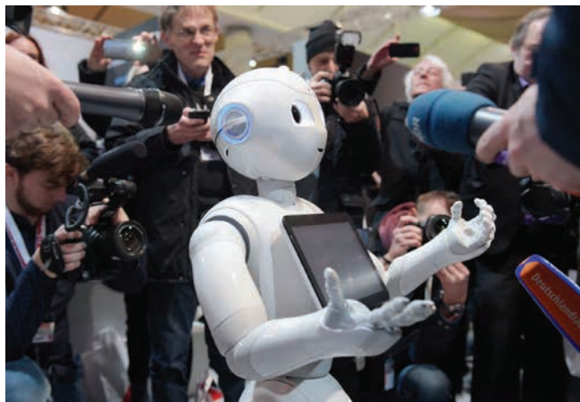
» Konverzacija v 20 jezikih in prepoznavanje razpoloženja sogovornika po izrazu obraza: humanoidni robot Peper mednarodnega podjetja Aldebaran, ki so ga razvili v sodelovanju z IBM-om
