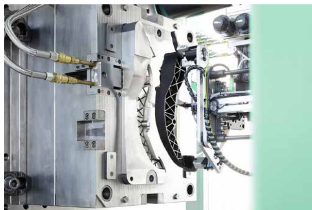
» Slika 4: Orodje za brizganje z izdelkom
