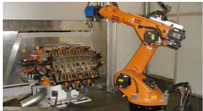
» Slika 8: Lasersko skenirno zavarivanje poklopca prtljažnika VW Pasata
