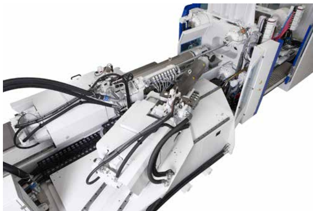
» Položaji agregata na ubrizgavalici MacroPower
