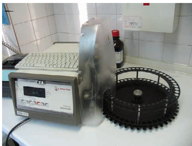
» Slika 2: Sodobni laboratorijski viskozimeter Stabinger SVM 3000/G2
