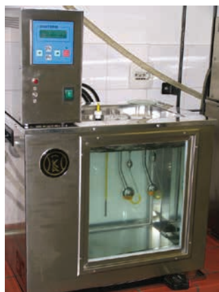
» Slika 1: a) Ostwald (1), Cannon-Fenske (2) in Ubbelohde (3) kapilarni viskozimeter [1], b) Cannon-Fenske kapilarni viskozimeter s temperirno kopeljo
