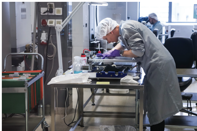
» V čistih prostorih čipe na silicijevih rezinah najprej stestirajo in razrežejo na žagi, zatem pa zalepijo na tiskana vezja, povežejo oziroma ožičijo ter avtomatsko zalijejo z epoksi smolo. Foto: Aleš Beno
