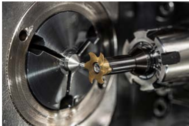
» Glodanje utora s pomoću sustava 606 za kružno glodanje. | Izvor: HORN/Sauermann
