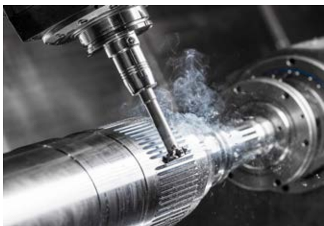
» Horn sustav za glodanje osigurava obradu bez vibracija čak i pri većim duljinama slobodnog dijela alata. | Izvor: HORN/Sauermann
