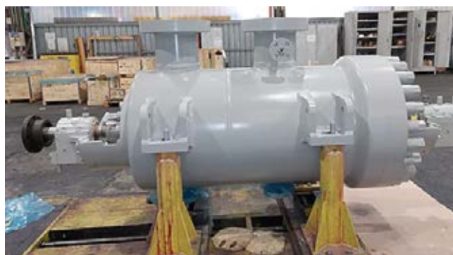
» Centrifugalna crpka u servisu Baker Hughes Bari u Italiji prije otpreme u Nizozemsku
