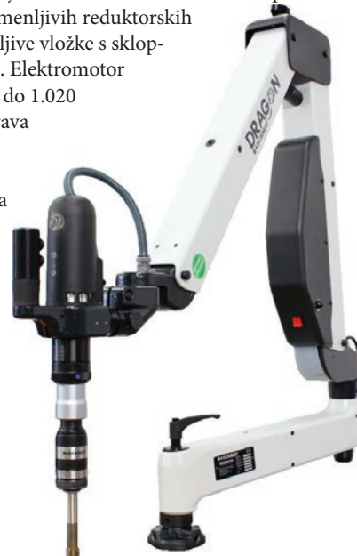
» Naprava za vrezovanje navojev Roscamat Dragon proizvajalca Tecnospiro za vrezovanje navojev do M27 oziroma M30. | Vir: Tecnospiro
