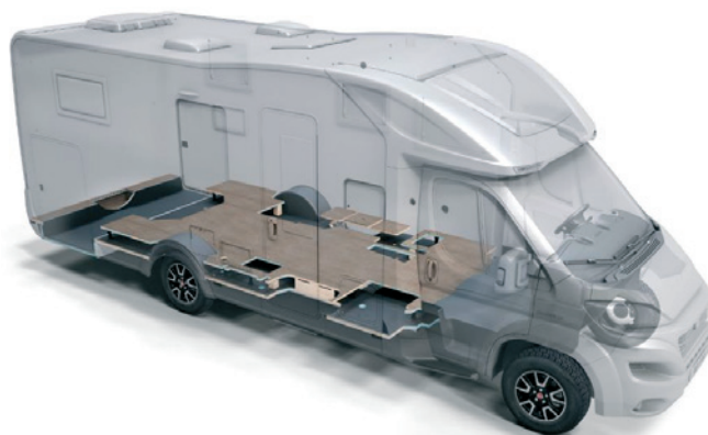
» Dvojni pod avtodoma podjetja Adria Mobil z nameščenimi distančniki iz Ceplafib kompozita
