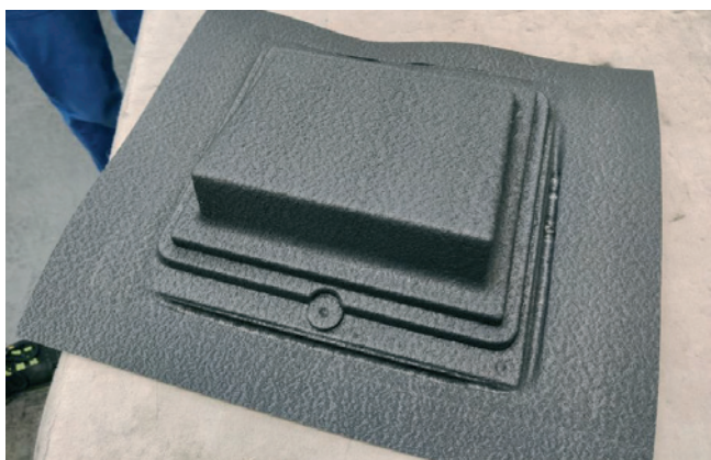
» Termoformirani zaščitni paneli za skrite inštalacijske sisteme v avtomobilih
