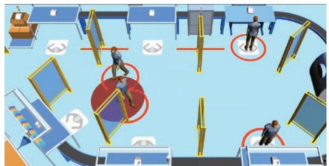
» Pri ponovnoj uspostavi proizvodnje tvrtka Siemens nudi svoj sustav lociranja u stvarnom vremenu (RTLS) kao rješenje za održavanje fizičke udaljenosti, koji može pratiti gibanje zaposlenika u proizvodnim pogonima te tako osigurava da radnici međusobno održavaju sigurnu udaljenost. | Izvor: Siemens
