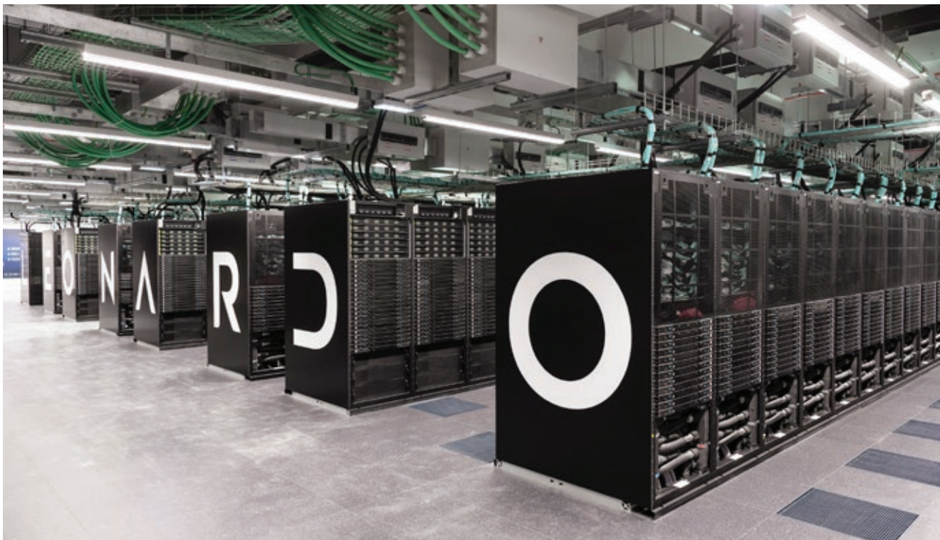
» Superračunalnik Leonardo sestavlja 136 BullSequana XH2000 tekočinsko hlajenih strežniških omar polne višine.
