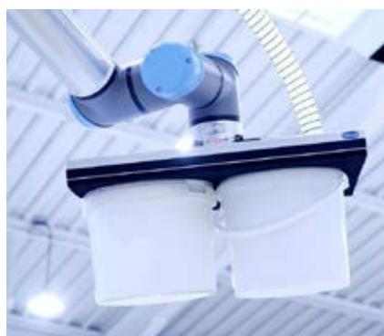
» ZLW je iznimno lagani prihvat, koji podigne do 20 kg, pri čemu ima masu svega između 4 i 7,5 kg, ovisno o dimenziji. Tako robot ima dovoljnu nosivost za manipuliranje s većom masom obratka. (Izvor: Schmalz)
