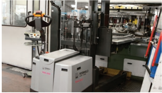
» Zaradi številnih ozkih mest z manj kot 3 metri manevrskega prostora okoli 2,5-tonske stiskalnice Andritz Kaiser in 1,6-tonske stiskalnice Haulick Roos mora biti transportno vozilo zelo okretno (Slika: ROEMHELD).
