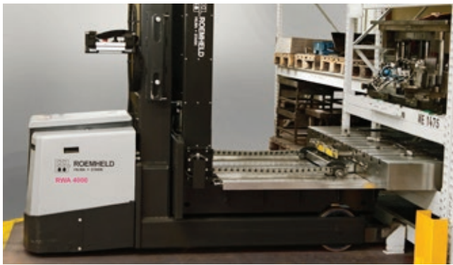
» Priključne tirnice s pripomočki za centriranje zagotavljajo varen prenos orodij med regalom in vozičkom ter med vozičkom in mizo stiskalnice (Slika: ROEMHELD).
