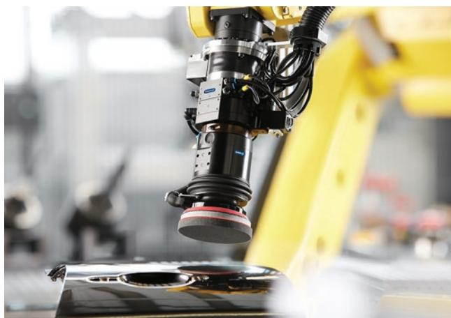
» Fleksibilni AOV može se opremiti adhezivnim diskovima za brušenje i poliranje te se stoga također ostvaruju savršeni rezultati kod poliranja.
