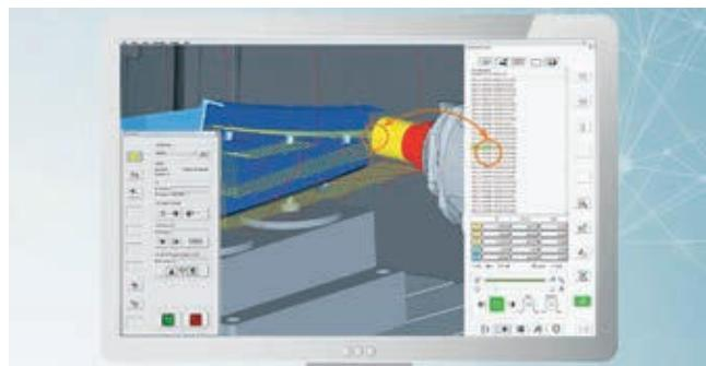
» Opcijski modul Optimizer rešitev na področju simulacij hyperMILL VIRTUAL Machining analizira celotno zaporedje obdelave ter upošteva omejitve osi posameznih obdelovalnih strojev. Vir: Open Mind
