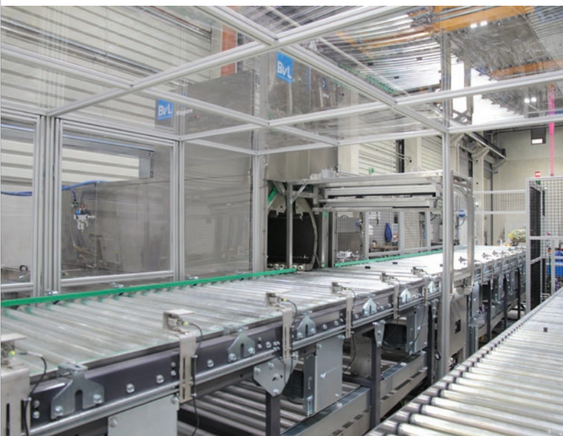
» Automatizirani sustav za čišćenje Niagara proizvođača BvL s valjčanim transportnim sustavom osigurava vrlo dobre rezultate pri čišćenju ležajeva i kućišta ležajeva. | Izvor: BvL Oberflächentechnik
