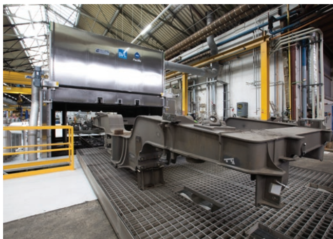
» Učinkovito čišćenje parova kotača i podvozja sa sustavom Pacific proizvođača BvL. | Izvor: www.GregorHartl.at
