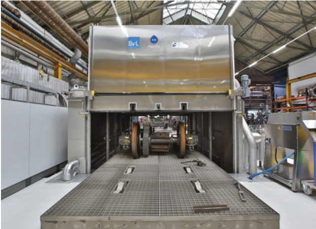
» Učinkovito čišćenje parova kotača i podvozja na sustavu Pacific proizvođača BvL. | Izvor: www.GregorHartl.at
