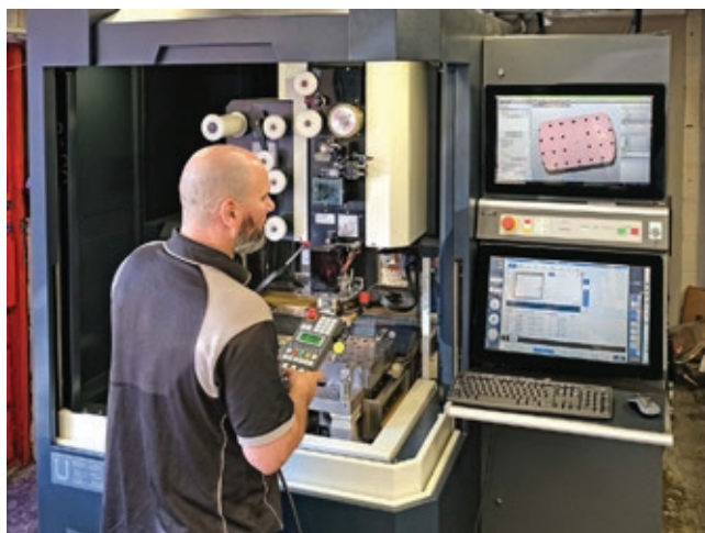
» Stroj za žično EDM obdelavo U32j v delavnici orodjarne BM Injection v angleškem mestu Whitchurch. Na desni strani je krmilnik z dvema zaslonoma, kjer je zgornji zaslon povezan s sistemom Open Mind CAM preko sistema za povezljivost HyperConnect, medtem ko se spodnji zaslon uporablja za nadzor procesa obdelave. Vir: NCMT
