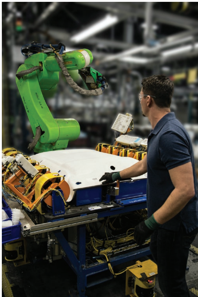
» Kolaborativni robot CR-35iA proizvajalca Fanuc dela v tandemu s tehnikom pri aplikaciji nanašanja lepila v avtomobilski industriji. | Vir: AutomationWorld
