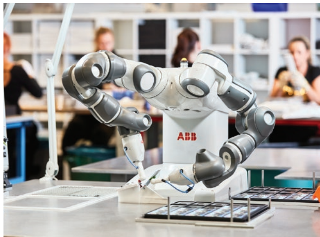
» Dvoročni kolaborativni robot YuMi proizvajalca ABB velja za prvega kolaborativnega robota na svetu. | Vir: AutomationWorld
