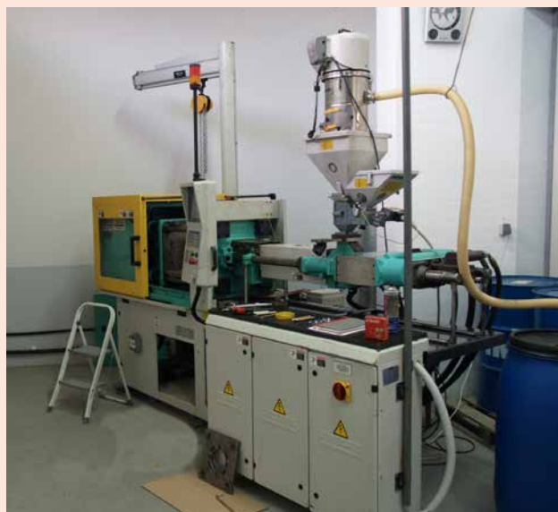
» Ubrizgavalica Arburg 320 K Allrounder sa silom zatvaranja od 77 tona
