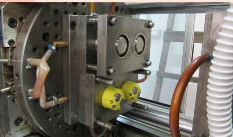
» Okretni stol s jezgrama kalupa za zrakonepropusnu razvodnu kutiju
