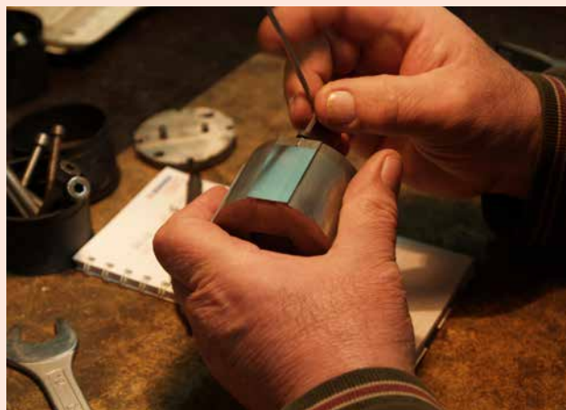
» Završna ručna obrada pri izradi žigova
