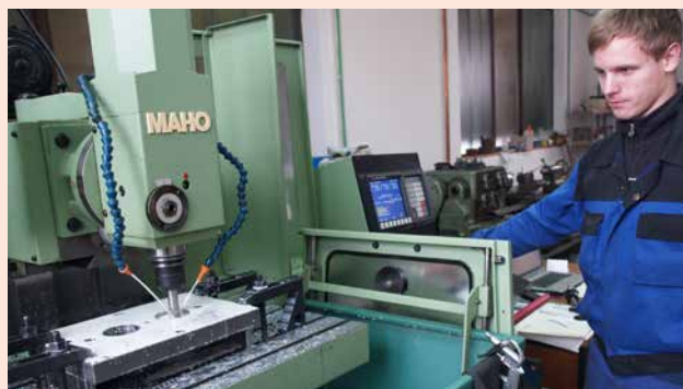
» NC glodalica Maho MH 500 u alatnici tvrtke P.I.T. Alarm
