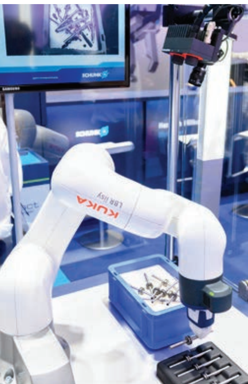
» Nakon što je cjenovno atraktivan rc_visard sustav iz Roboceptiona definirao je optimalne točke prihvata za nesortirani dio u < 1 s, KUKA kobot je koristio SCHUNK Co-act hvatač za uklanjanje dijela i umetanje u zamišljeni stroj potpuno automatski. U bilo kom trenutku, djelatnik može intervenirati u proces u tijeku. | Foto: Roboception
