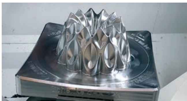
» GENOS M460V-5AX omogoča izdelavo kompleksnih geometrij v eni nastavitvi. Vir: Okuma
