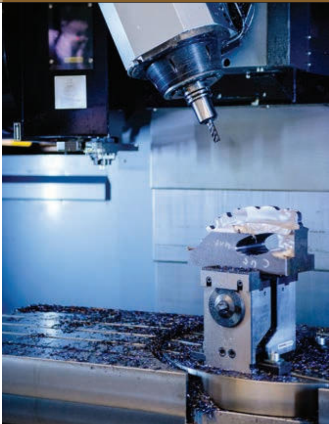
» Obrada s kombinacijom okretnog stola i glave obradnog centra serije SRTi proizvođača HURCO. | Izvor: HURCO
