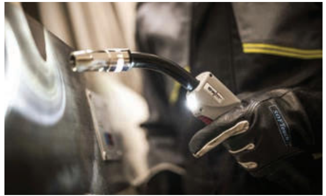
» Novi PM gorionik za zavarivanje s ugrađenom LED-rasvjetom omogućuje rad na tamnijim dijelovima obratka.
