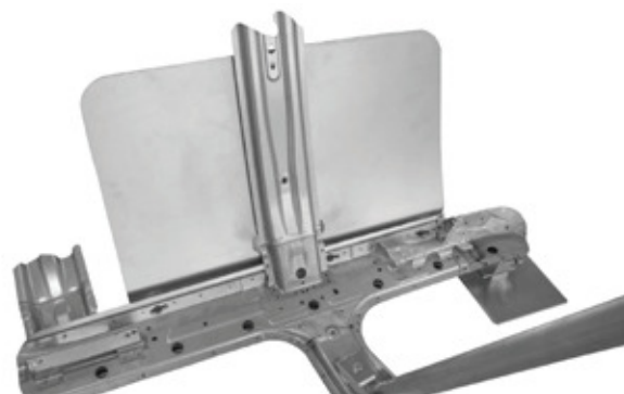
» Slika 2: Dodatni, skupi procesi spajanja, kao što je npr. spajanje zakovica, postaju prošlost uz primjenu CMT zavarivanja – što dovodi do veće troškovne učinkovitosti.
