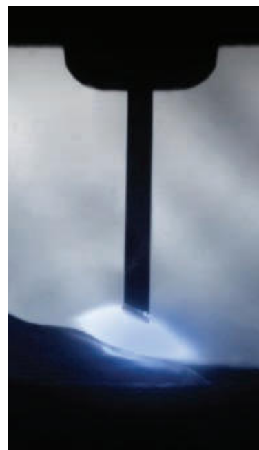
» Slika 4: U procesu CMT zavarivanja je faza izlučivanja vrlo kratka i unos topline manji. S tim procesom unos energije možemo stalno prilagođavati, kako bi odgovarao komponenti koju je potrebno zavarivati.
