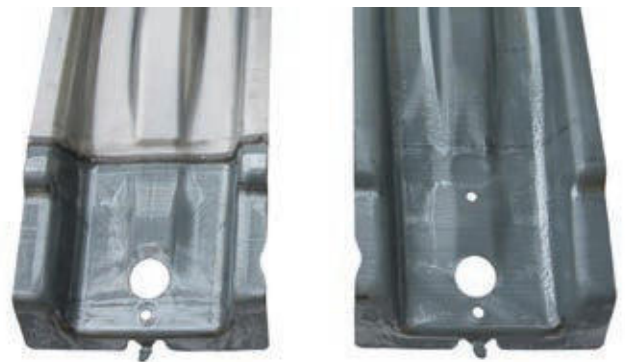
» Slika 1: S pomoću postupka zavarivanja CMT tvrtke Fronius moguće je pouzdano i učinkovito spojiti čelik i aluminij.
