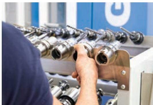
» Ker so adapterji orodnih sestavov prosto dostopni, se nevarnost ureznin praktično odpravi.
