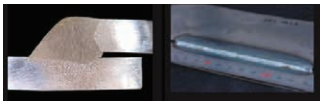
» Preklopni spoj, debljina materijala 3 mm
