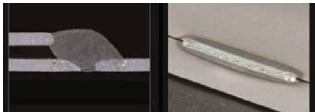
» Preklopni spoj, debljina materijala 0,6 mm
