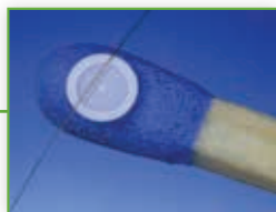
149 Mikro injekcijsko prešanje za medicinsku tehnologiju
