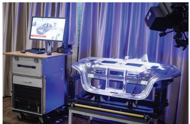
» Precizna mjerena s pomoću sustava ATOS pri oblikovanju lima iznimno su važna u industriji auto dijelova, a predstavljena su na radionici održanoj uz konferenciju
