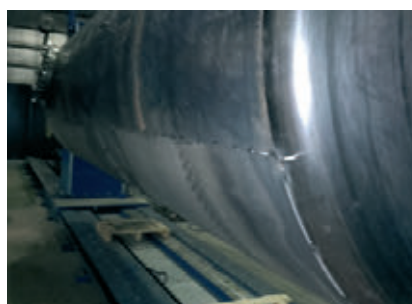
» Slika 2. Kovinska cisterna s točkovnimi zvari
