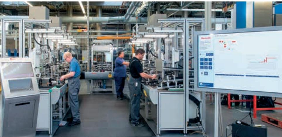
» Na proizvodnoj traci u pogonu Bosch Rexroth-a proizvodi se više od 200 vrsta različitih ventila. Na desnoj strani slike je ActiveCockpit, interaktivna komunikacijska platforma Bosch Rexroth-a, koja unosi, obrađuje, analizira i prikazuje podatke o proizvodnji koja se odvija na ovoj traci. Pogledajte naš video korištenjem QR koda!
