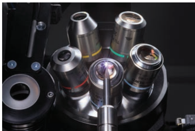
» Mikroskopska optika mjernog stroja Helicheck Nano omogućuje mjerenje na nanometarskoj razini. | Izvor: Walter
