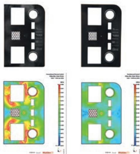
» Simulacija smičnih naprezanja (dolje) predviđa kvalitetu površine otpresa od PA6-GF30. Primjena variotermalne regulacije temperature kalupa (desno) osigurava postizanje bolje kvalitete površine otpresa. | Izvor: SimpaTec
