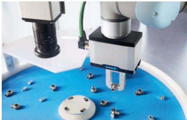
» S novim 2D kompletom za prihvat - ovdje je u kombinaciji s novim električnim univerzalnim prihvatom EGU - moguće pouzdano rukovati sa slučajno raspoređenim predmetima na ravnini. | Slika: SCHUNK
