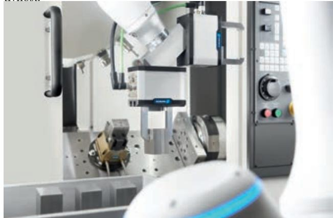
» Robustan i svestran: električni univerzalni prihvatac posebno je primjereno za prilagodljivo punjenje i pražnjenje obradnih strojeva. Na raspolaganju je sa svim uobičajenim komunikacijskim priključcima, funkcijama PLC modulima i utičnicama vodećih proizvođača robota. | Slika: SCHUNK
