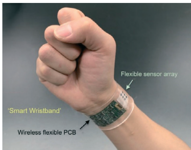
» Pametna zapetnica z integriranimi MEMS – tehnologijami.
